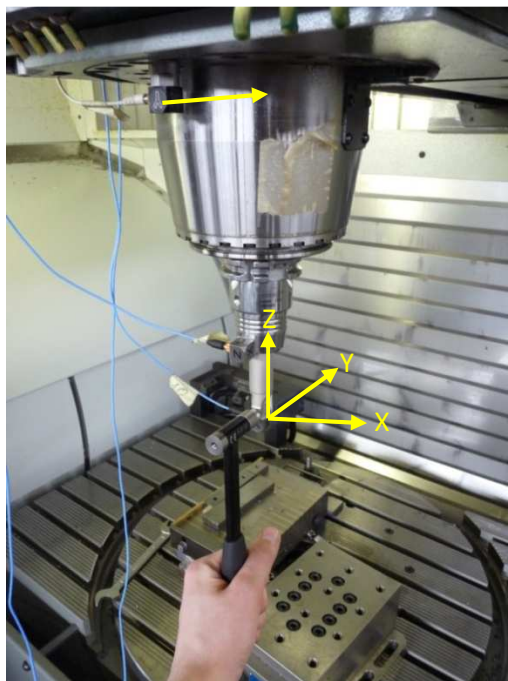
Rys. 2. Test impulsowy przeprowadzony dla wyznaczenia macierzy częstotliwościowych funkcji przejścia Fig. 2. Impulse test conducted for the construction of the matrix transfer function
