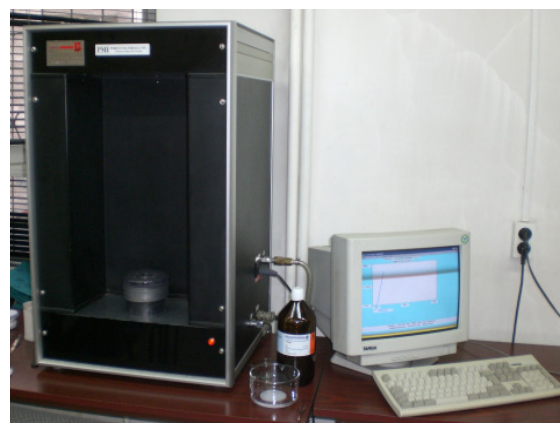
Rys.4. Porometr kapilarny firmy PMI [8]
