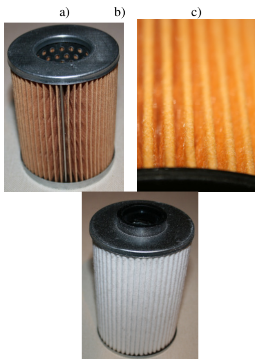
Rys. 1. Widok filtrów przed wymontowaniem warstwy filtracyjnej:
