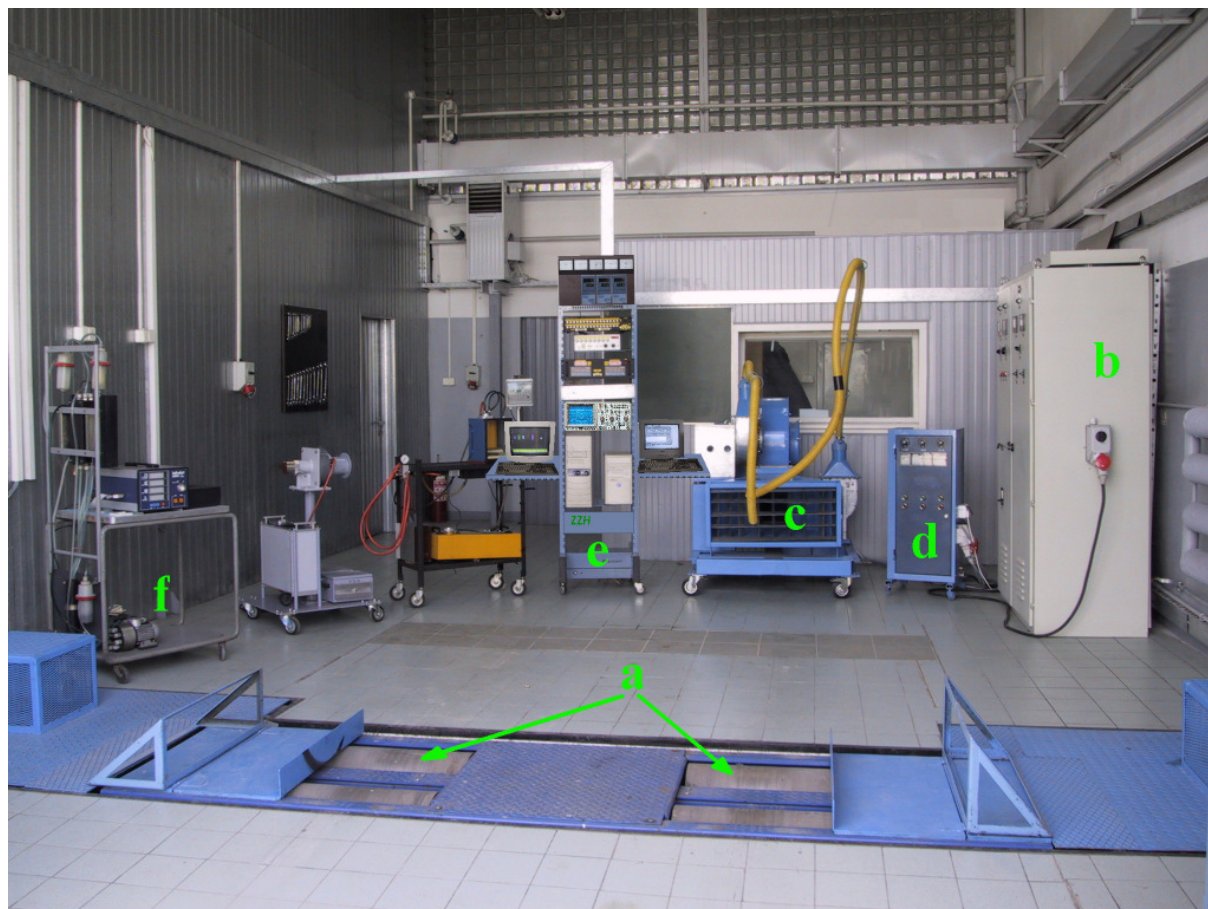
Rys. 1. Hamownia podwoziowa w Zakładzie Mechatroniki Samochodowej Politechniki Radomskiej a – rolki, b – sterownik napędu elektrycznego rolek, c – zespół wentylatorów, d – sterownik wentylatorów, e – zestaw komputerów pomiarowych i sterowników urządzeń hamowni, f – system analizy spalin
