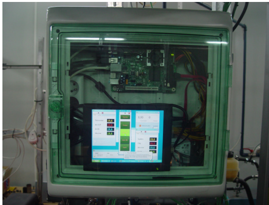
Rys. 4.1 Sterownik zarządzający systemem z akumulatorem ciepła w badaniach stanowiskowych na hamowni silnikowej Fig. 4.1. Controller of the system with the heat storage during engine test stand investigations
