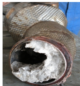
F_1a. Osad na wlocie do reaktora katalitycznego SCR
