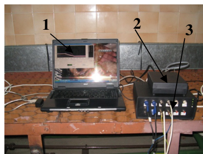
Rys. 3. Aparatura pomiarowa stosowana w badaniach: 1 – komputer, 2 – uniwersalny moduł
