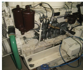
Rys. 4. Widok instalacji paliwowej silnika typu SW400 umożliwiającej odcięcie dopływu paliwa do wybranego wtryskiwacza
