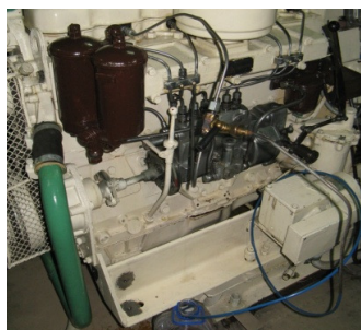
Rys. 4. Widok instalacji paliwowej silnika typu SW400 umożliwiającej odcięcie dopływu paliwa do wybranego wtryskiwacza
