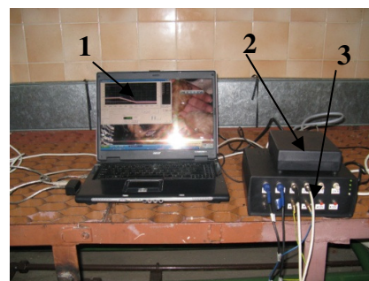
Rys. 3. Aparatura pomiarowa wykorzystywana w badaniach: 1 – komputer, 2 – karta pomiarowa, 3 – przetwornik wielkości mierzonych
