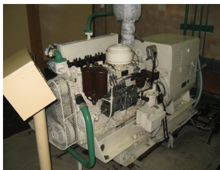
Rys. 1. Widok ogólny morskiego zespołu prądowłórczego ZE400/52 na stanowisku laboratoryjnym
