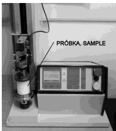
Rys. 7. Maszyna wytrzymałościowa wraz ze ściskaną próbką. Fig. 7. Strength machine with compressed sample.
