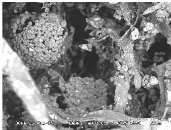
Rys. 1 Obraz mikroskopowy izolacji z materiałem fazowo-zmiennym w postaci mikrokapsulek
