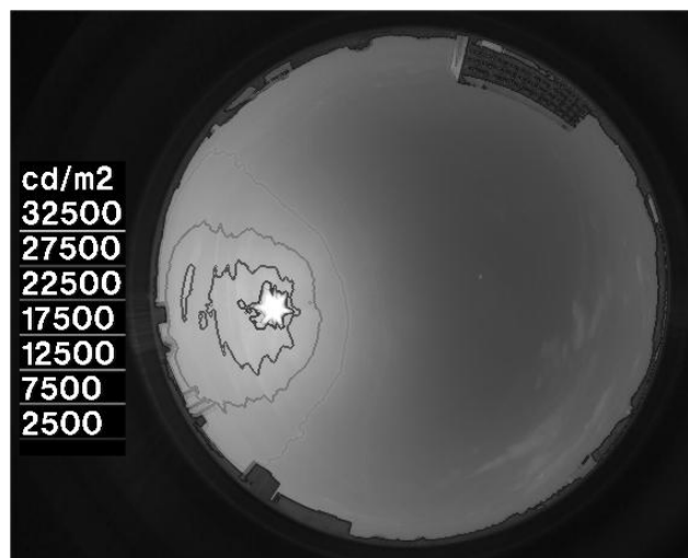
Rys. 6. Rozkład luminancji na nieboskłonie uzyskany techniką HDR (izolinie). Fig. 6. Sky luminance distribution obtained by HDR technique.
