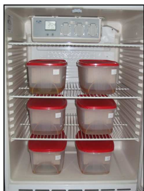
Rys. 1 Komora klimatyczna ze szczelnymi pojemnikami. Fig. 1. Climatic chamber with tightly closed boxes.
