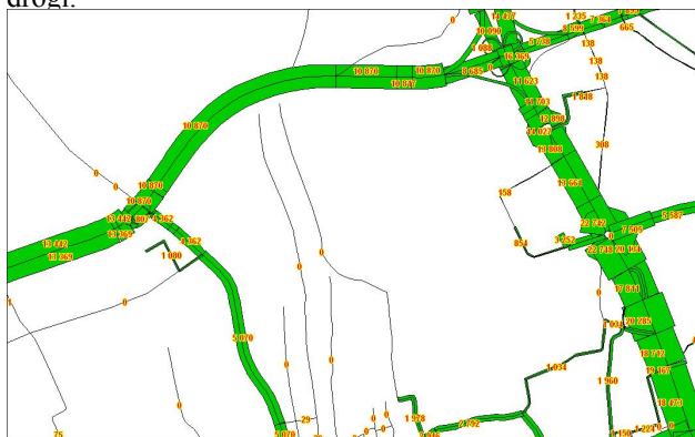
Rys. 4. Opracowany na potrzeby wykonania mapy akustycznej model ruchu dla analizowanego układu komunikacyjnego. Fig. 4. Traffic model of the analyzed transportation system used to make acoustic map.
