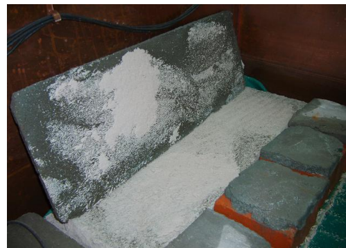
Fot. 5. Odspojona od betonu komórkowego warstwa zaprawy cementowej po 25 cyklach zamrażania – odmrażania.
