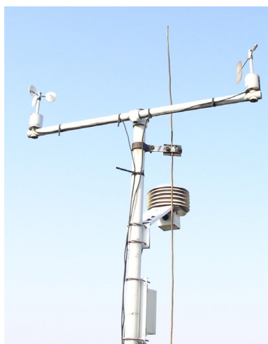
Fot. 2. Zespolony czujnik temperatury powietrza atmosferycznego i wilgotności względnej, czujnik ciśnienia atmosferycznego oraz czujniki kierunku i prędkości wiatru.
