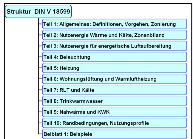
Abbildung 5: Aufbau der DIN V 18599 Energetische Bewertung von Gebäuden
