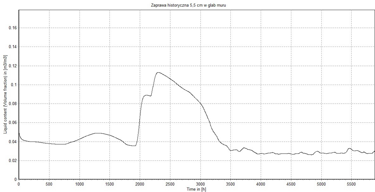
Rys. 13. Historia zmian zawartości wody [m 3 /m 3 ] w spoinie cementowej na głębokości 5,5 cm od strony zew. od stycznia do sierpnia. Fig. 13. Liquid content history [m 3 /m 3 ] in cement plaster 1 cm from external surface, from January to August.
