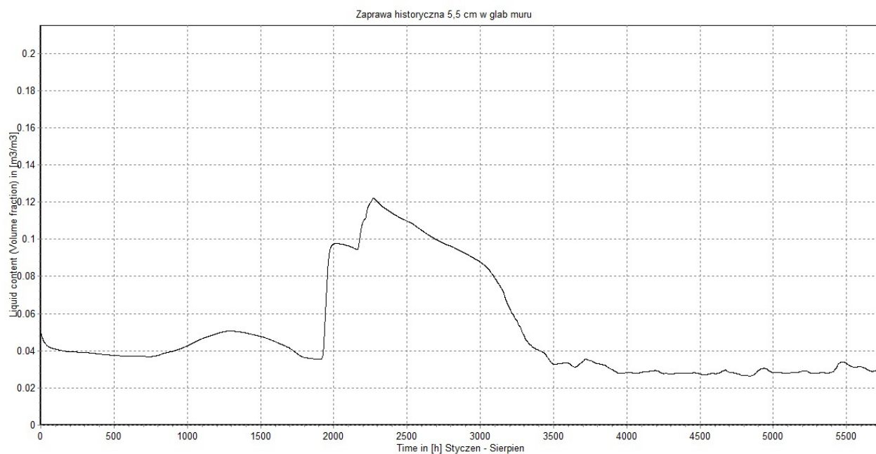
Rys. 11. Historia zmian zawartości wody [m 3 /m 3 ] w spoinie cem-wap. na głębokości 5,5 cm od strony zew. od stycznia do sierpnia. Fig. 11. Liquid content history [m 3 /m 3 ] in lime-cement plaster 5,5 cm from external surface, from January to August.
