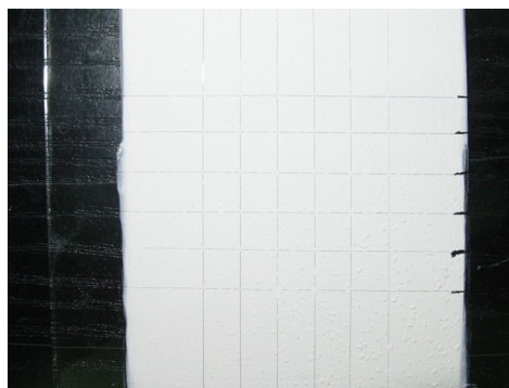
Rys. 4. Przyczepność próbek do podłoża.
