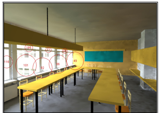
Rys. 4. Rozkład luminancji dla wybranego pola widzenia [cd/m 2 ]. Fig. 3. Luminance distribution for selected view point [cd/m 2 ].
