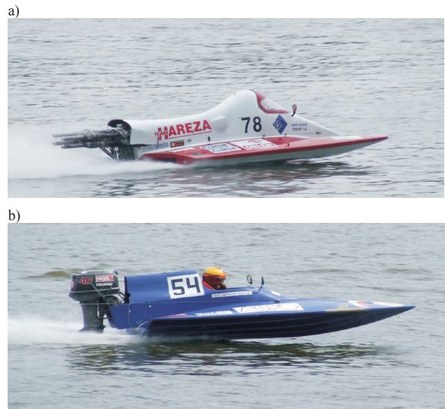
Rys. 1. Przykładowe klasy i serie motorowodne: a) seria „O” – łodzie wyścigowe typu katamaran z silnikiem przyczepnym, silniki nieseryjne, dopuszczalne własne konstrukcje, b) seria „T” – łodzie jednokadłubowe typu „V” z silnikiem przyczepnym, silnik seryjny, przeróbki niedopuszczalne
