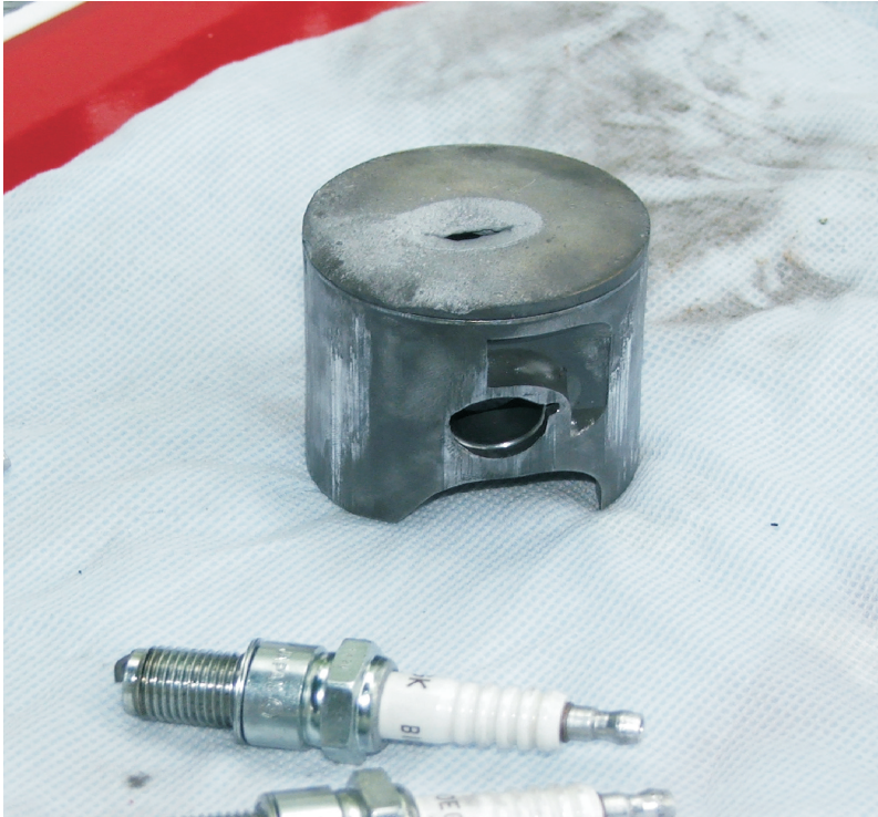
Rys. 12. Wypalenie denka tłoka spowodowane niewłaściwym stosunkiem mieszaniny paliwa z powietrzem
