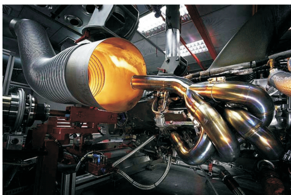
Rys. 3. Badanie silnika Formuły 1 na hamowni silnikowej
