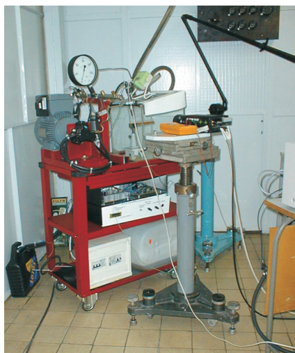
Rys. 1. Stanowisko do badań optycznych strugi wtryskiwanego paliwa oraz przykład zarejestrowanego obrazu
