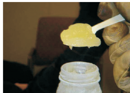
Rys. 14. Galaretowaty charakter biopaliwa w niskich temperaturach
