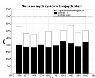
Rys. 1 Obliczeniowe roczne zyski energetyczne z instalacji solarno-wiatrowej Fig. 1 Calculated annual energy gains from the hybrid photovoltaic wind installation
