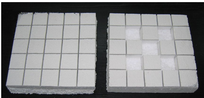
Rys.3. Wygląd makiety przed i po badaniu przyczepności . Fig.3. A specimen of ETICS before and after the adhesiveness test.
