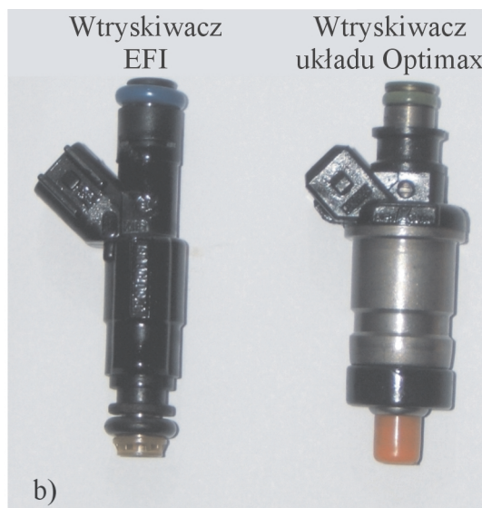
Rys. 17. Budowa wtryskiwacza układu wtryskowego EFI (a) oraz porównanie wtryskiwaczy typu EFI i (b) wtryskiwacz z układu Optimax: a) zawór iglicowy, b) dysza, c) końcówka wtryskiwacza, d), g), m), s) O-Ring, e) nasadka zaworu iglicowego, f) rdzeń, h) sprężyna, i) obudowa, j) uzwojenie cewki, k) taśma, l) szpuła, n) pierścień wewnętrzny, o) nakładka, p) przyłącze, q) wtyczka, r) filtr
