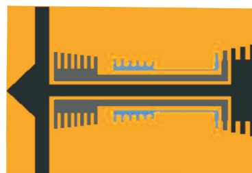
Rys. 27. Schemat układu wirników dwuprzepływowego silnika turbinowego RB211-535
