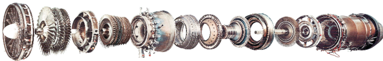
Rys. 25. Modułowa budowa silnika turbinowego F404-GE-400
