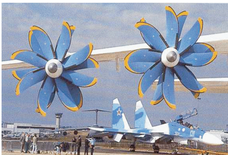
Rys. 23. Łopaty „śmigłowentylatorów” samolotu An-70
