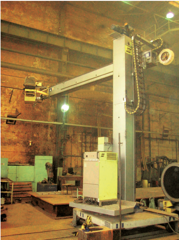
Rys. 7. Stanowisko do spawania łukiem krytym Esab 460 MaB i złącze poprzecznic (odlew)-blacha poprzeczna Fig. 7. Esab 460 MaB station for submerged-arc welding, and joint between bearing support (casting) and transverse plate
