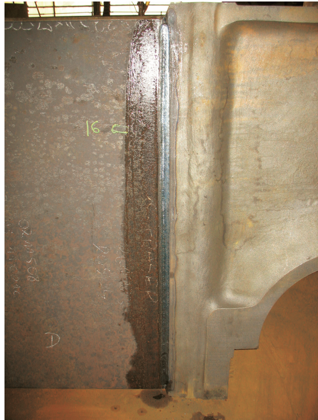
Rys. 7. Stanowisko do spawania łukiem krytym Esab 460 MaB i złącze poprzecznic (odlew)-blacha poprzeczna Fig. 7. Esab 460 MaB station for submerged-arc welding, and joint between bearing support (casting) and transverse plate
