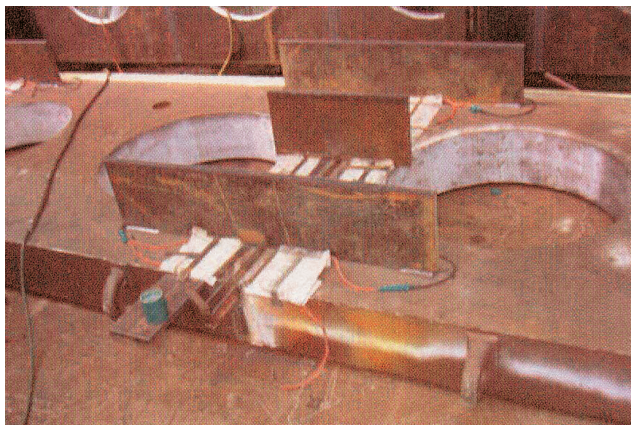
Rys. 20. Widok przygotowania płyt do szepiania i spawanie płyt stalowych [3]
