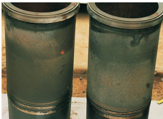
Rys. 8. Tuleje cylindrowe przy zastosowaniu płynu chłodzącego Coolelf Supra po 10 490 godzinach pracy Fig. 8. After using Coolelf Supra organic technology coolant during 10 490 operating hours
