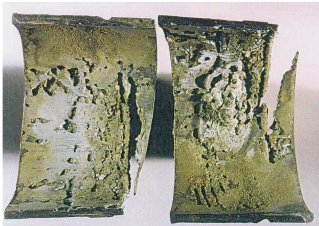
Rys. 4. Zniszczone przez erozję części awaryjnego obwodu chłodzącego silnika 8 MW w reaktorze atomowym
