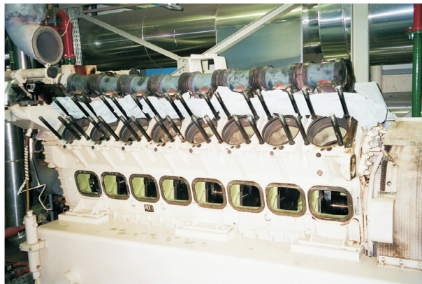
Rys. 6. Kadłub silnika przy zastosowaniu płynu chłodzącego Coolelf Supra po 10 490 godzinach pracy Fig. 6. After using Coolelf Supra organic technology coolant during 10 490 operating hours
