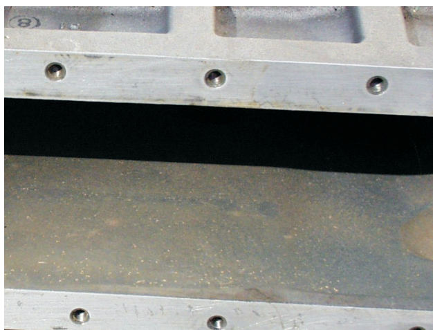
Rys. 10. Aluminiowa osłona wymiennika ciepła przy zastosowaniu płynu chłodzącego Coolelf Supra po 7240 godzinach pracy Fig. 10. After using Coolelf Supra organic technology coolant during 7240 operating hours
