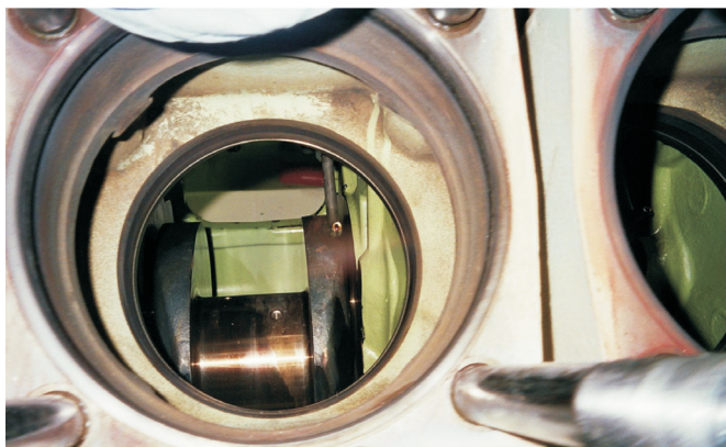
Rys. 6. Kadłub silnika przy zastosowaniu płynu chłodzącego Coolelf Supra po 10 490 godzinach pracy Fig. 6. After using Coolelf Supra organic technology coolant during 10 490 operating hours
