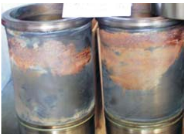
Rys. 7. Tuleje cylindrowe przy zastosowaniu konwencjonalnego płynu chłodzącego po 7080 godzinach pracy Fig. 7. After using usual coolant during 7080 operating hours
