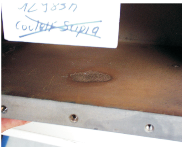
Rys. 9. Aluminiowa osłona wymiennika ciepła przy zastosowaniu konwencjonalnego płynu chłodzącego po 12 980 godzinach pracy Fig. 9. After using usual coolant during 12 980 operating hours
