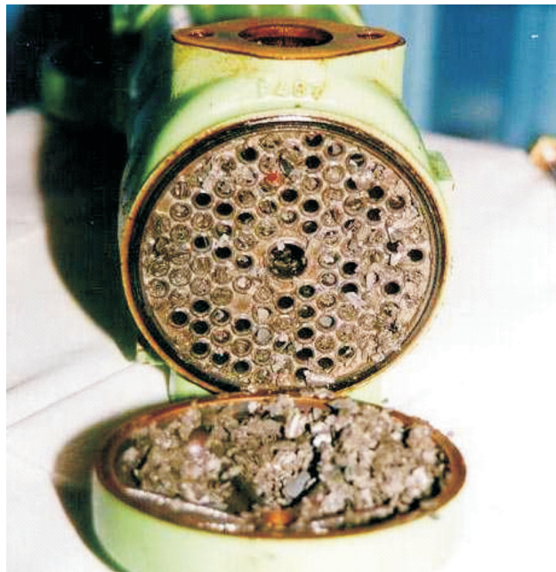
Rys. 2. Czteromegawatowy wymiennik ciepła zablokowany przez osady powstałe pod wpływem inhibitorów organicznych zwartych w konwencjonalnym płynie chłodzącym po 18 miesiącach użytkowania
