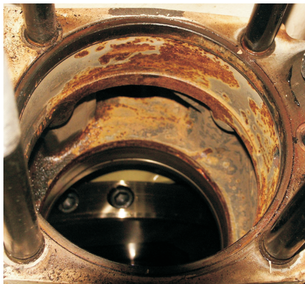
Rys. 5. Kadłub silnika przy zastosowaniu konwencjonalnego płynu chłodzącego po 12 980 godzinach pracy
