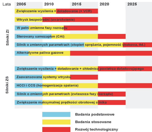
Rys. 22. Najważniejsze kierunki rozwoju samochodowych silników ZI i ZS według FURORE [3]
