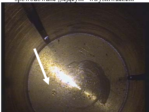
Tłok w tulei cylindrowej silnika Mercedes MB620 – widoczne wgniecenia na powierzchni denka tłoka
