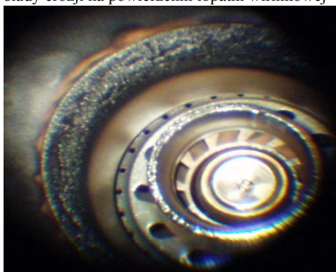
Wtryskiwacz komory spalania silnika LM-2500 – ślady nagaru na powierzchni dyszy wtryskiwacza
