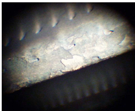
I st. turbiny wytwornicy spalin silnika LM-2500 – ślady erozji na powierzchni łopatki wirnikowej
