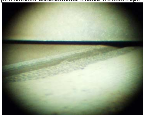
XII st. sprężarki silnika LM-2500 – ubytek materiału w uszczelnieniu wieńca wirnikowego
