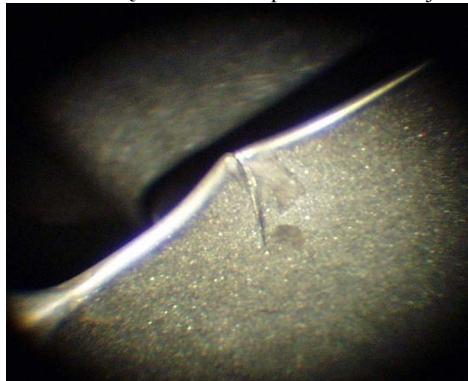
IX st. sprężarki silnika LM-2500 – wgniecenie z pęknięciem na krawędzi natarcia łopatki wirnikowej
