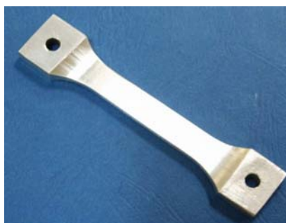
Fot. 1. Próbką o przekroju prostokątnym ze stopu aluminium-magnez AlMg5 o wymiarach 3×10 mm wycięta z arkusza blachy i poddana obróbce skrawaniem
