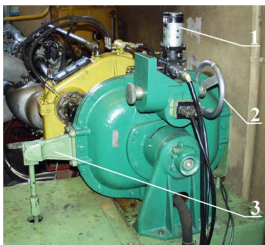
Rys. 3. Hamulec obciążający – wodny Froude'a typu HWZ-3:
