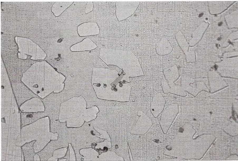
Rys. 6. Mikrostruktura przekroju skrzydła o grubości 45 mm; wydzielienia fazy \alpha (białe) w fazie \beta' (szare tło) i wydzielienia fazy \kappa (czarne, grubsze, skupione); pow. 480x
