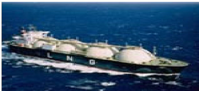
Rys. 4. Statek do przewozu LNG w wersji ze zbiornikami kulistymi
