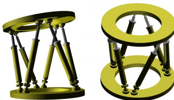
Rys. 11. Projekt platformy Stewarda do posadowienia zestawu ZU-23-2MR
