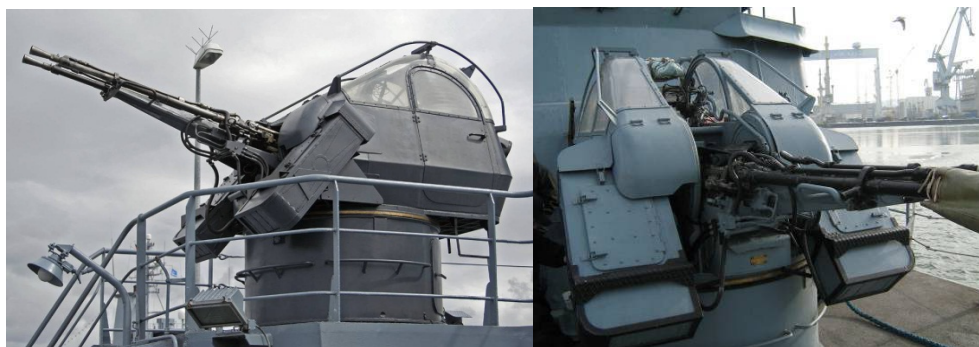
Rys. 1. Zestaw ZU-23-2MR kal. 23 mm (bez rakiet)
