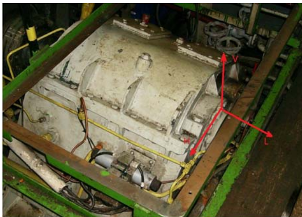
Rys. 2. Punkt montażu akcelerometrów na kadłubie przekładni Zamech AWS 160
