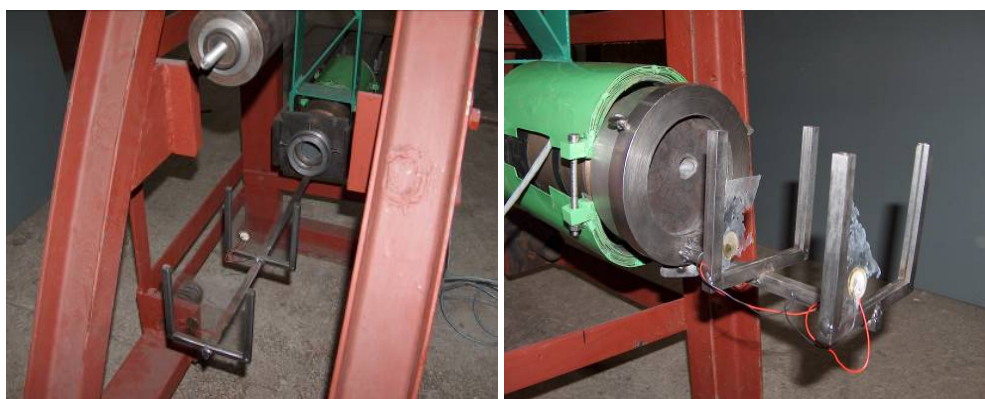
Rys. 3. Widok wahadła balistycznego z zamontowaną próbką [10]
