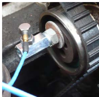
Rys. 2. Sposób umieszczenia czujnika piezoelektrycznego w kierunku równoległym do osi tulei cylindrowej
