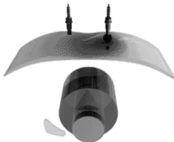
Rys. 3. Komora spalania silnika Wankla w warunkach minimalnej objętości
