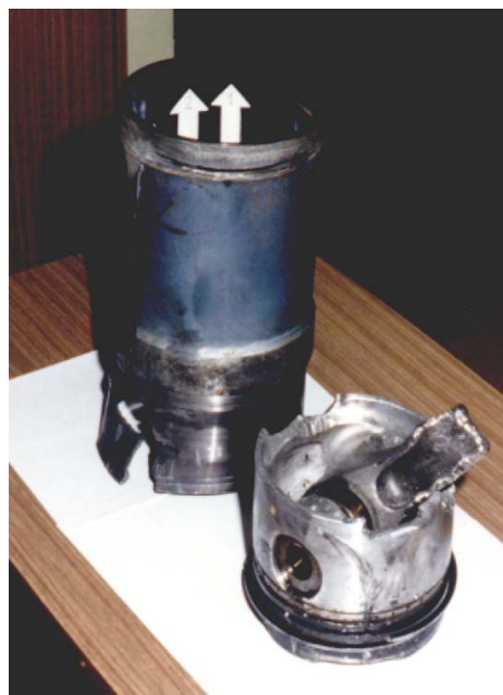
Rys. 4. Urwanie korbowodu w silniku M520
