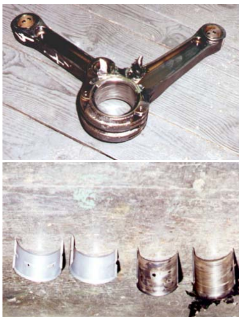
Rys. 3. Uszkodzenie łożyska silnika M50
