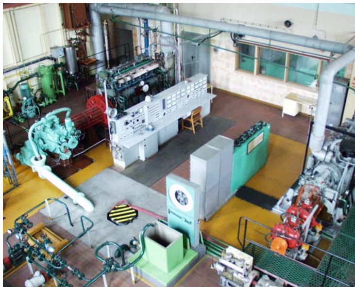
Fot. 1. Stanowiska hamowni silników okrętowych Sulzer typu 6AL20/24 i Henschel typu 57H6Aa w laboratorium IKiEO
