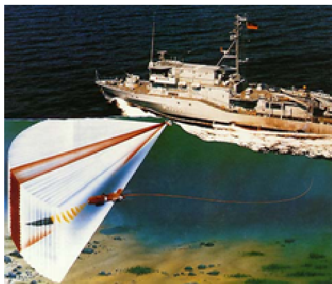
Rys. 7. Użycie do identyfikacji i niszczenia min pojazdu podwodnego wielokrotnego użycia
