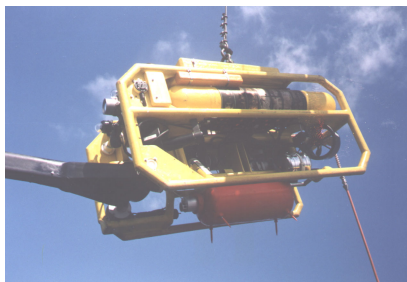
Rys. 9. Użycie do niszczenia min pojazdu podwodnego UKWIAŁ z ładunkiem wybuchowym TOCZEK A
