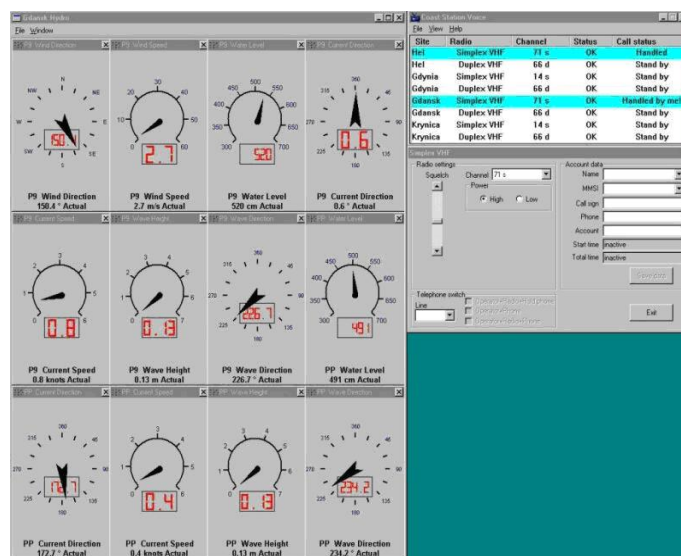
Rys. 6. Wizualizacja wskazań czujników hydrometeorologicznych systemu VTS Zatoka Gdańska
