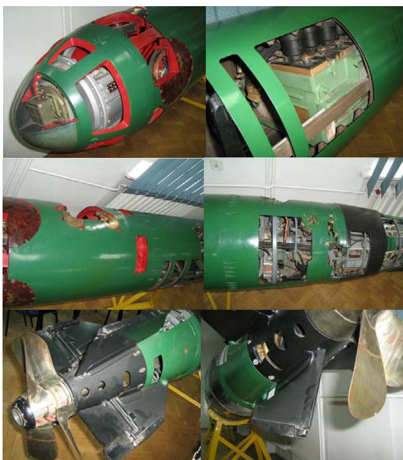
Fot. 1. Torpeda SET 53 z przekrojami w IUO AMW
