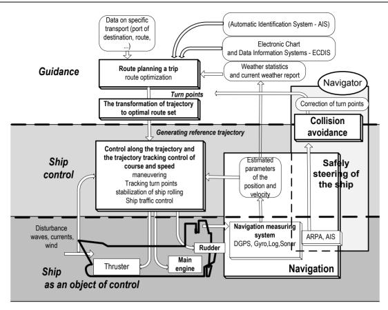
Fig. 2. The structure of multi-layer vessel traffic management Rys. 2. Struktura wielowarstwowa kierowania ruchem statku
