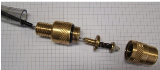
Fig. 9. The probe head and its components Rys. 9. Górna część sondy i jej elementy
