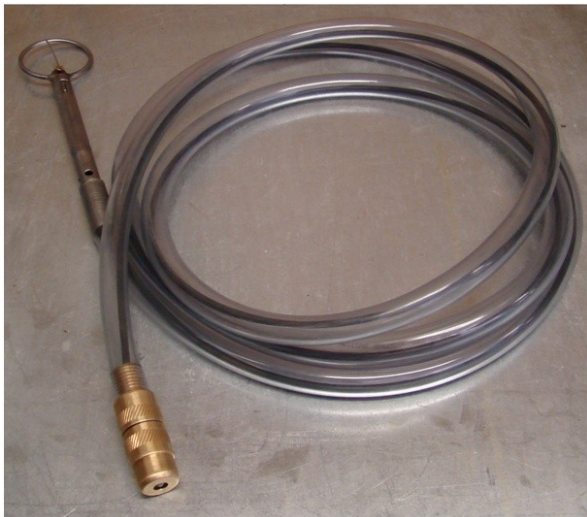
Fig. 8. The sampling probe used for taking fuel samples Rys. 8. Sonda służąca do pobierania próbek paliwa
