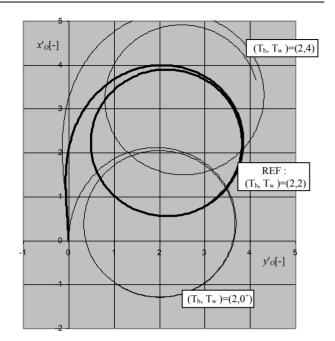
Fig. 3. The effect of yaw time constant  $T_w$  on trajectory Rys. 3. Wpływ stałej czasowej prędkości kątowej na trajektorię
