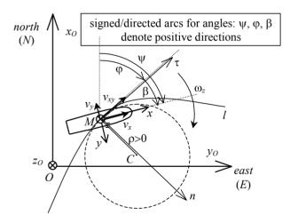
Fig. 1. Definition of ship kinematics Rys. 1. Kinematyka ruchu statku po trajektorii – oznaczenia
