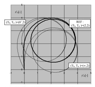
Fig. 2. The effect of drift time constant  $T_b$  on trajectory Rys. 2. Wpływ stałej czasowej kąta dryfu na trajektorię
