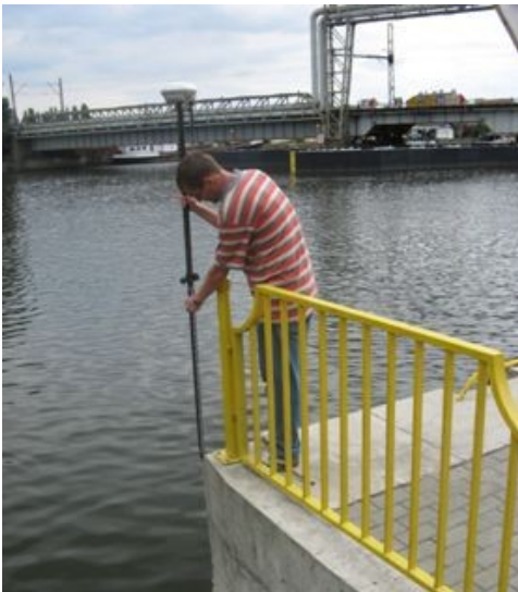
Fig. 4. Measuring of shoreline points on the West Odra River Rys. 4. Pomiar punktów linii brzegowej na Odrze Zachodniej
