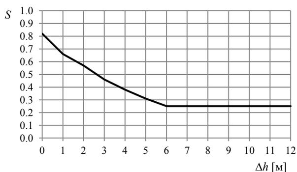
Рис. 1. График  $S(\Delta h)$  для судна 507 проекта (движение при полной загрузке)
