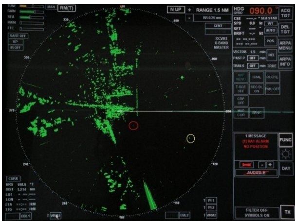
Fig. 9. Radar Raytheon NSC-34. Image on range 1.5 NM. Circles mark buoys “GS” (red, right) and “GP” (yellow, left) Rys. 9. Radar Raytheon NSC-34. Zobrazowanie na zakresie 1.5 NM. Okręgi oznaczają pławy „GS” (czerwony) and „GP” (żółty)
