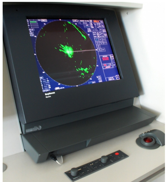
Fig. 3. Pulse radar Raytheon NSC-34 display unit Rys. 3. Wskaźnik radaru impulsowego Raytheon NSC-34
