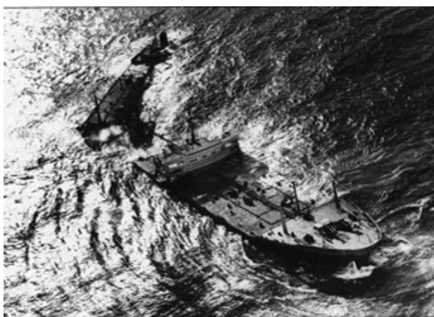
Fig. 1. Crash of super tanker “Torrey Canyon” at the English channel because of undetected failure gyrocompass Rys. 1. Śmierć supertankowca „Torrey Canyon” w kanale La Manche z powodu niewykrytego uszkodzenia żyrokompasu
